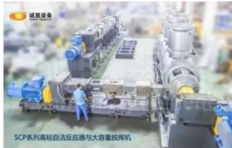
降解片材混炼挤出压延成型生产线
